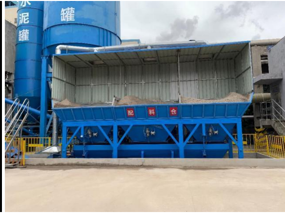
محطة وزن الركام متعددة الخزانات | خزان وقادوس تغذية الركام
