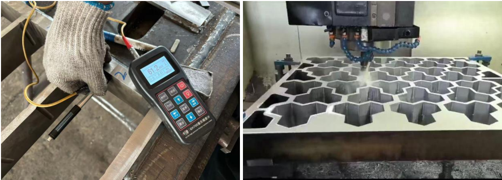
تشغيل تجاويف القالب باستخدام CNC | فحص صلادة أجزاء القالب
